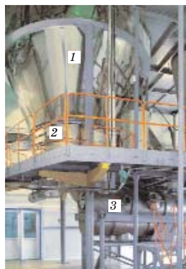
Рис. 8. Тристадійна розпилювальна сушарка (1) з флюїдним днищем (2) і віброфлюїдайзером (3) А1-ОР2Ч
