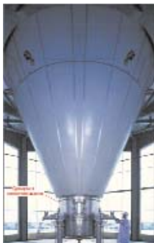
Рис. 5. Розпилювальна сушарка компанії Niro для одержання порошку розчинної кави зі вбудованою сушаркою киплячого шару (тип FSD)
