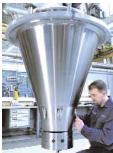
Рис. 15. Виготовлення сушарки, яка відповідає вимогам GMP (GEA Niro Atomizer)
