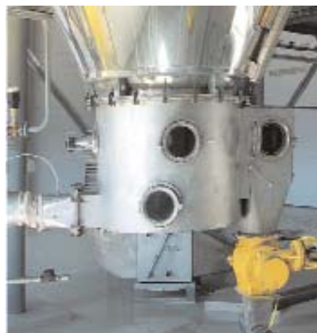
Рис. 6. Флюїдне днище двоступеневої сушарки А1-ОР2Ч для сушіння молока (Калинівський машзавод, Україна)
