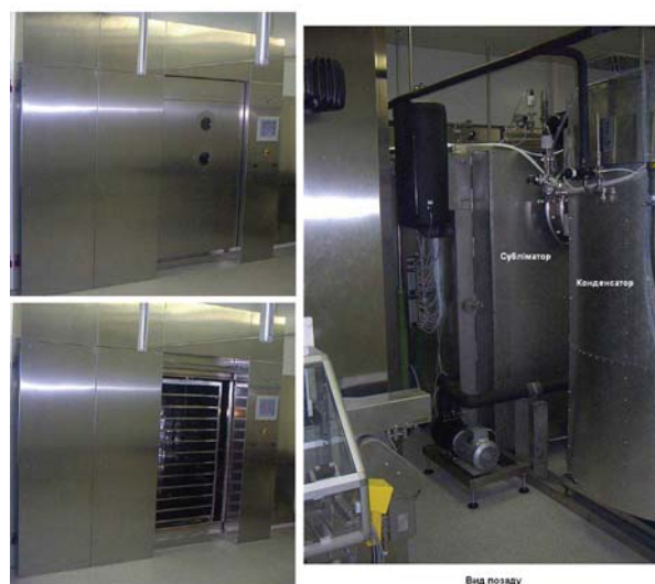
Рис. 13. Sublimator 300-13: площа полиць 13 м 2 , cGMP, CIP-SIP, продуктивність за льодом 300 кг/добу
