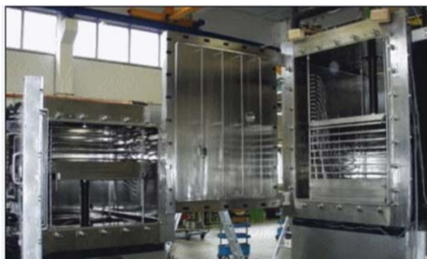
Рис. 4. Сушарка EPSILON 2-400 DS (площа 29,8 м 2 ; завантаження-вивантаження здійснюється за допомогою гідравлічної системи)
