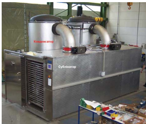
Рис. 14. Sublimator 800-90 зі спареними конденсаторами: площа полиць 90 м 2 , продуктивність за льодом 2х400 кг/добу
