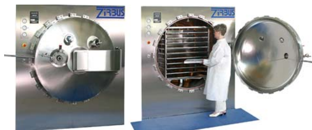
Рис. 16. Sublimator 150-6: площа полиць 6,5 м 2 , cGMP, CIP-SIP, продуктивність 150 кг/добу
