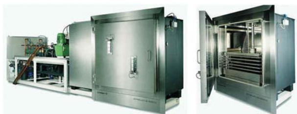
Рис. 2. Сушарка EPSILON 2-220 D з корисною площею 18 м 2
