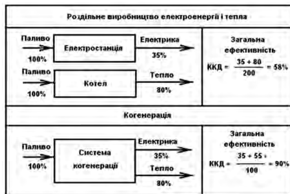
Рис. 26. Порівняння ККД когенерації з роздільним виробництвом електроенергії і тепла
