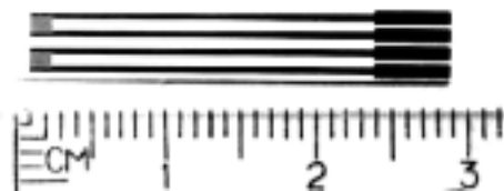
Рис. 1. Зовнішній вигляд кондуктометричного планарного гребінчастого перетворювача
