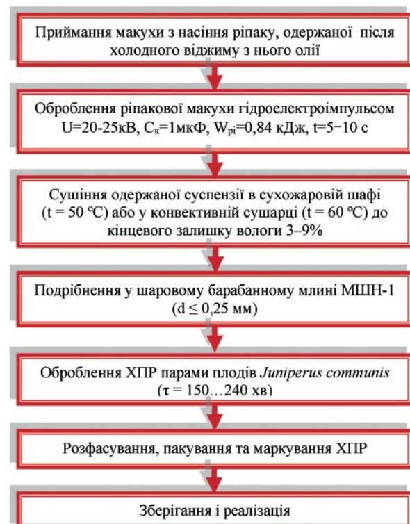
Схема послідовності технологічних процесів під час одержання «Харчового продукту для спеціального дієтичного споживання "Ріпаковий"»
