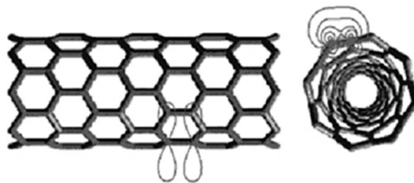
Рис. 4. Схема перекриття електронних орбіталей у вуглецевих нанотрубках в різних напрямках
