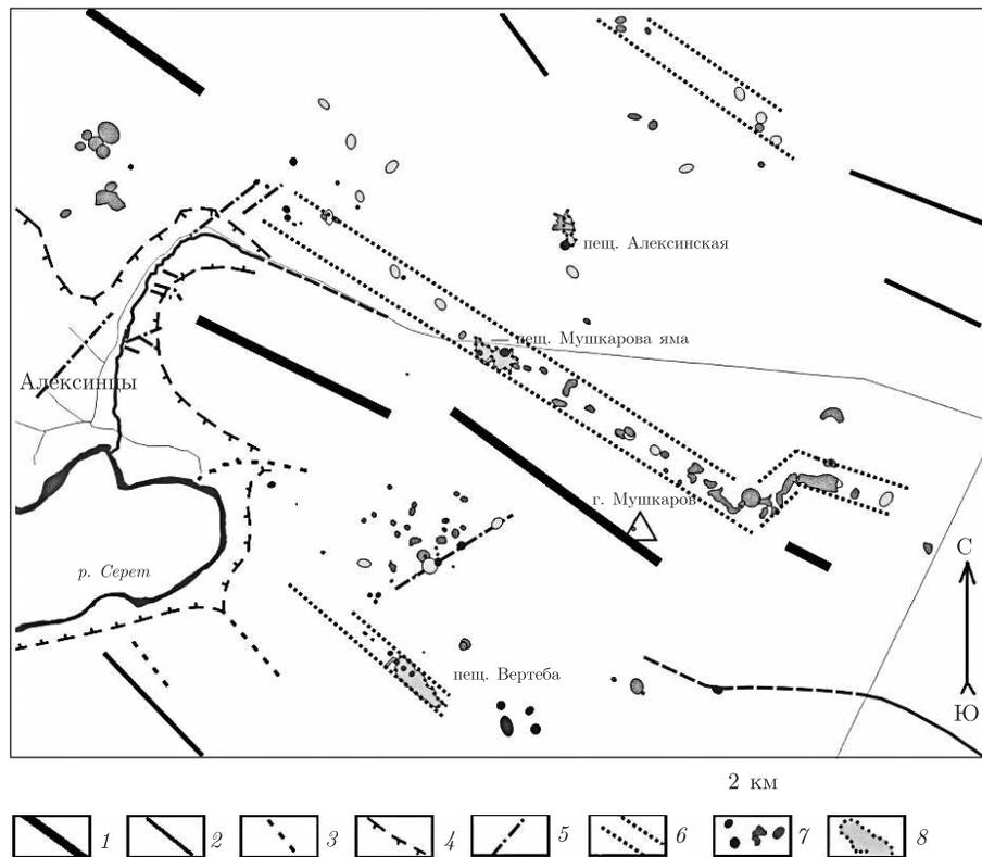
Рис. 3. Схема расположения карстовых воронок и элементов орографии в районе пещеры Мушкарова яма: 1 — оси главных водораздельных холмов; 2 — оси второстепенных холмов; 3 — сухие тальвеги; 4 — край возвышенного слабохолмистого плато; 5 — разломы; 6 — линейные зоны повышенной плотности закарстования; 7 — воронки свежие и погребенные; 8 — контуры пещер
