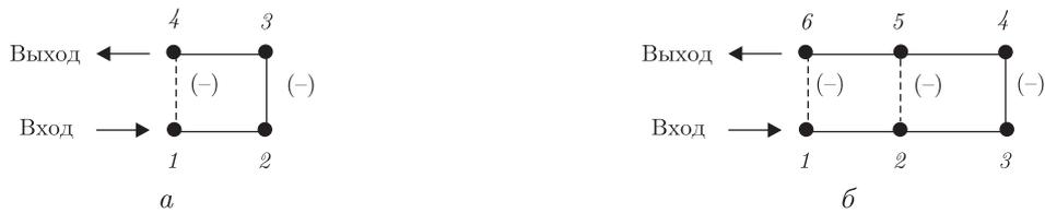
Рис. 1. Структуры канонических неминимально-фазовых фильтров задержки: *а* — четырехрезонаторного фильтра; *б* — шестирезонаторного фильтра
