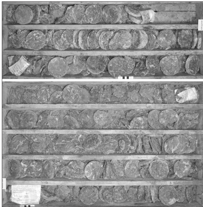
Рис. 2. Различная степень саморазрушения керна карбонатных пород уолсортских куполов в зависимости от глубины залегания.
