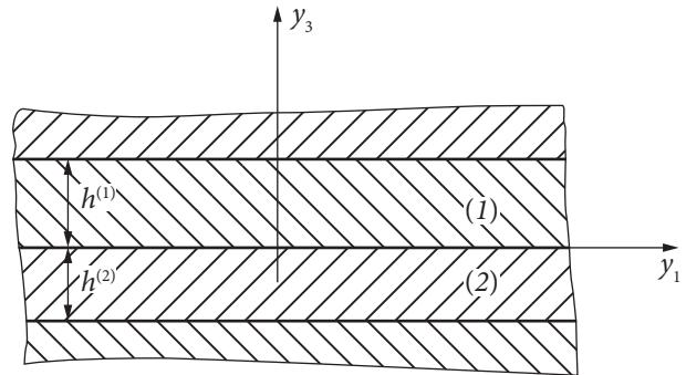
Розрахункова схема шаруватого двокомпонентного композитного матеріалу періодичної структури
