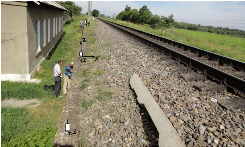
Рис. 1 – Місця розташування вібродатчиків під час дослідження підпірної стінки
