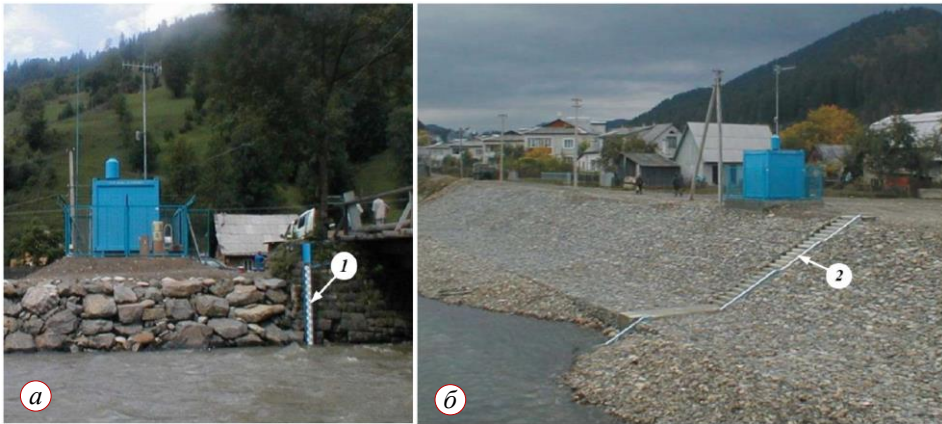
Рис. 3 – Автоматизовані вимірювальні станції інформаційно-вимірювальної системи «Тиса», призначеної для короткострокового прогнозу паводків в басейні р. Тиса на Закарпатті [22]: а – на р. Біла Тиса у с. Луги; б – на р. Ріка у смт Міжгір'я; 1 – водомірна рейка вертикальна; 2 – водомірна рейка похила
