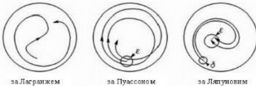
Рис. 1 – Якісна ілюстрація стійкості за Лагранжем (траєкторія залишається в замкнутій області), за Пуассоном (траєкторія багаторазово повертається в \varepsilon -околицю стартової точки) і за Ляпуновим (дві близькі на старті траєкторії залишаються близькими завжди) [4]
