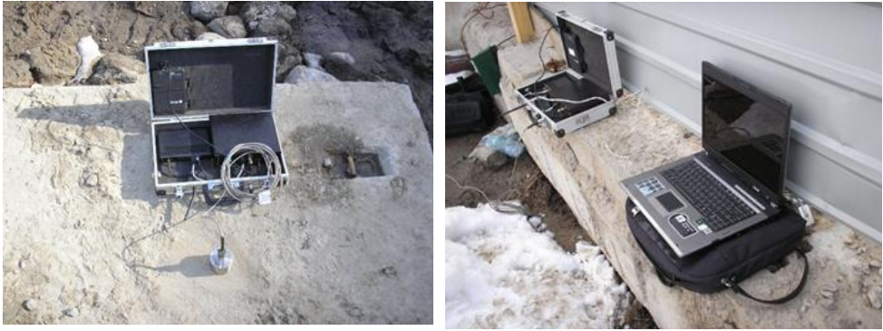
Рис. 3 – Загальний вигляд віброметричної апаратури під час її тарування при динамічних дослідженнях ґрунту
