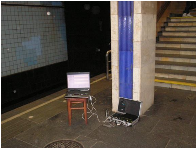
Рис. 4 – Загальний вигляд віброметричної апаратури під час її тарування і при динамічних дослідженнях конструкцій
