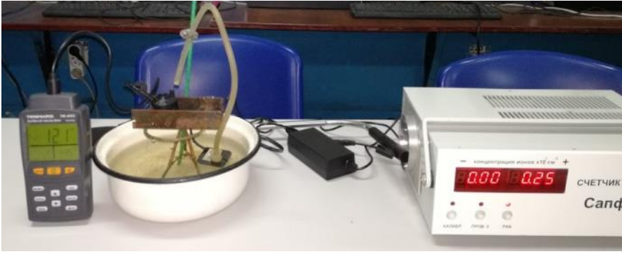
Рис. 1. Комплекс дослідження динаміки концентрації аероіонів за рахунок балоелектричного ефекту й ультразвукової кавітації
