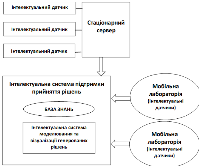
Рис. 2. Структурна схема інтелектуальної системи підтримки прийняття екологічних рішень системи
