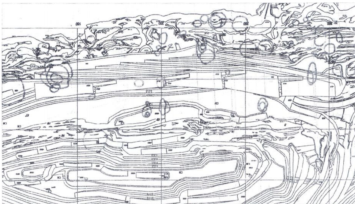
Рисунок 2 – План горных работ Глееватского карьера при формировании рабочей зоны восточного борта наклонными слоями: выделено подземные пустоты, выработки, зоны возможного обрушения
