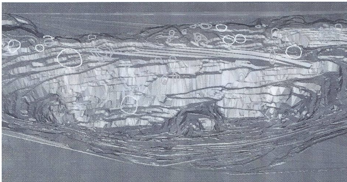
Рисунок 3 – Общий вид Глееватского карьера (ЦГОК №1) при формировании рабочей зоны восточного борта наклонными слоями
