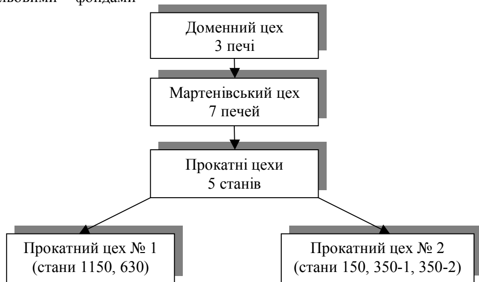
Рис. 8. Схема технологічного ланцюжка основного виробництва ЗАТ «Макіївський металургійний завод»
