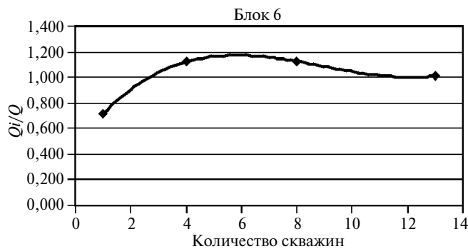
Графики зависимости отношения рассчитанной величины запасов углеводородов к оценке их действительной величины от количества разведочных скважин Юлиевского газоконденсатного месторождения. Горизонт В-20
