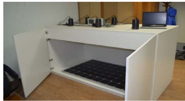
Рис. 1. Блок-схема (а) та зовнішній вигляд (б) стенду для дослідження ФЕМ
