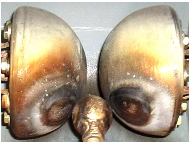
Рис. 2. Увеличенный вид трехэлектродной системы ВСВК каскадного типа с двумя массивными основными полусферическими электродами и одним управляющим сферическим электродом из стали марки Ст.3 на номинальное напряжение \pm 50 кВ и импульсный микросекундный ток амплитудой I_m до \pm 300 кА (вид после однократного воздействия на ее стальные электроды в разрядной цепи ВЭФУ с мощным ЕНЭ импульсного затухающего синусоидального тока частотой \omega/2\pi = 4,9 кГц и первой амплитудой I_{ms} = -202 кА; J_a = 2,12 \cdot 10^6 Дж/Ом; опытное значение радиуса канала искры r_{cm} \approx 31 мм; длина канала искры l_c \approx 13,5 мм)
