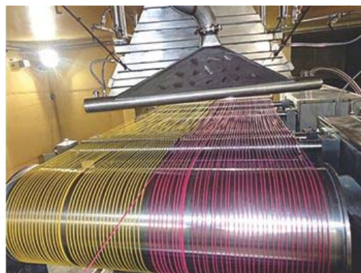
Рис. 1. Компоновка электронного ускорителя для облучения изоляции кабелей и проводов
