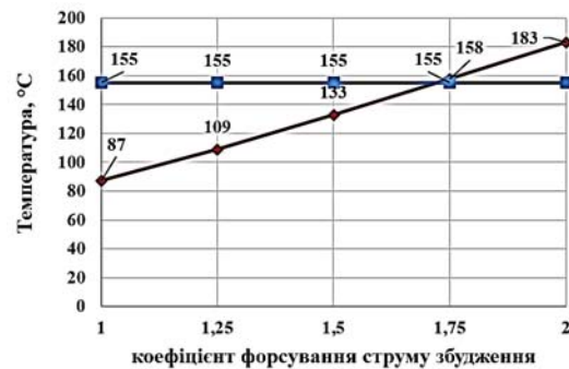
Рис. 7. Максимальна температура в пазу ротора нешкодженого ТГ в залежності від коефіцієнта форсування струму збудження
