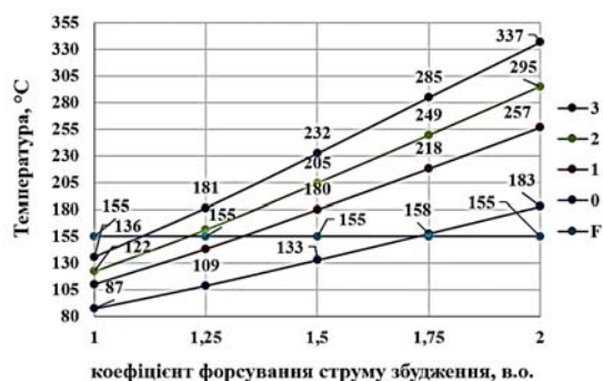
Рис. 10. Максимальна температура в роторі ТГ в залежності від коефіцієнта k_f при різній кількості засмічених каналів і відсутності к.з. витків ОР
