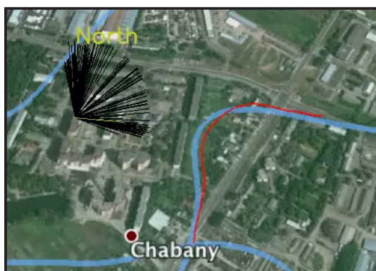
Рис. 6. Реконструкция пути БПЛА по видео: красный цвет — путь, проложенный с использованием ASIFT; синий цвет — фактический путь по данным GPS
