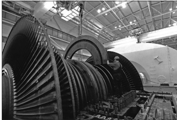
Рис. 1. Парова турбіна К-1000-60/3000 для енергетичних реакторів ВВЕР-1000
