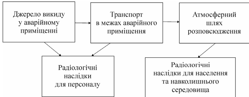
Рис. 1. Структурна схема моделювання радіаційних наслідків аварій та небезпечних подій на АЕС
