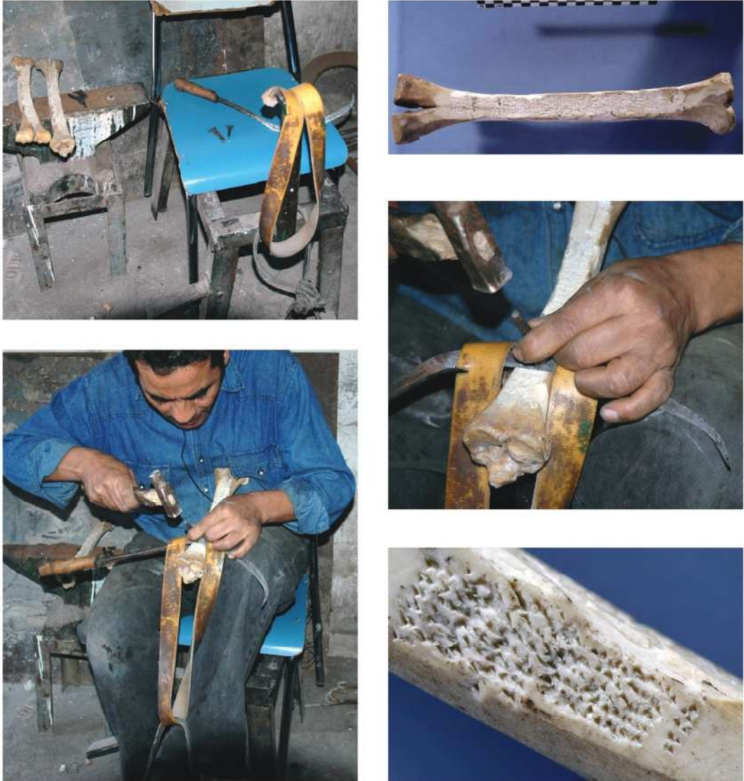
Рис. 4. Робочий інвентар і процес заточки серпа сучасного коваля з Тунісу. (за Anderson et. al. 2014)
