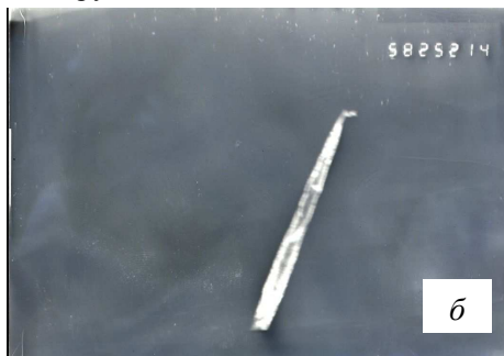
Рис. 4. ТЕМ-зображення конусоподібних нанотрбок BN з розвиненою поверхнею (а, б) та електронограма нанотрубки (в).
