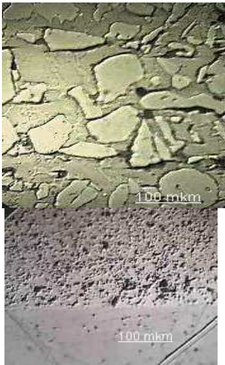
Рис. 2. Пористость композиционного покрытия \text{Cr}_3\text{C}_2 —ПГ-10-Н01 с разным содержанием связки ПГ-10 (% (об.)): a — 15; б — 20; в — 30.
