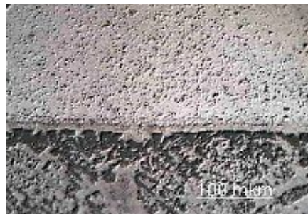
Рис. 2. Пористость композиционного покрытия \text{Cr}_3\text{C}_2 —ПГ-10-Н01 с разным содержанием связки ПГ-10 (% (об.)): a — 15; б — 20; в — 30.
