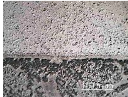
Рис. 1. Структура слоя композита, образовавшегося после взаимодействия насыпанных слоев порошков карбида \text{Cr}_3\text{C}_2 и связки ПГ-10-Н01 в результате выдержки при 1200 °С 30 мин в вакууме. Слой \text{Cr}_3\text{C}_2 насыпался сверху.
