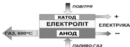
Рис. 3. Схема роботи керамічної паливної комірки, побудованої на аноді.
