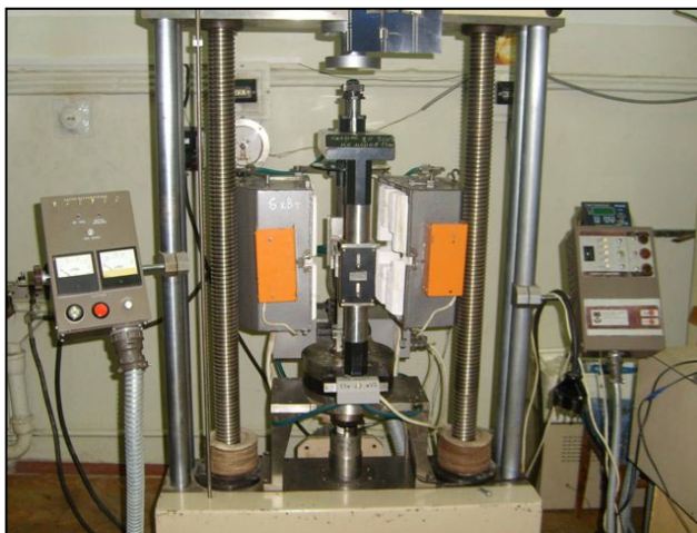
Рис. 1. Машина TermoTest для випробувань жароміцних сплавів на деформування та руйнування під час згину на повітрі за температури до 1000 °С.
