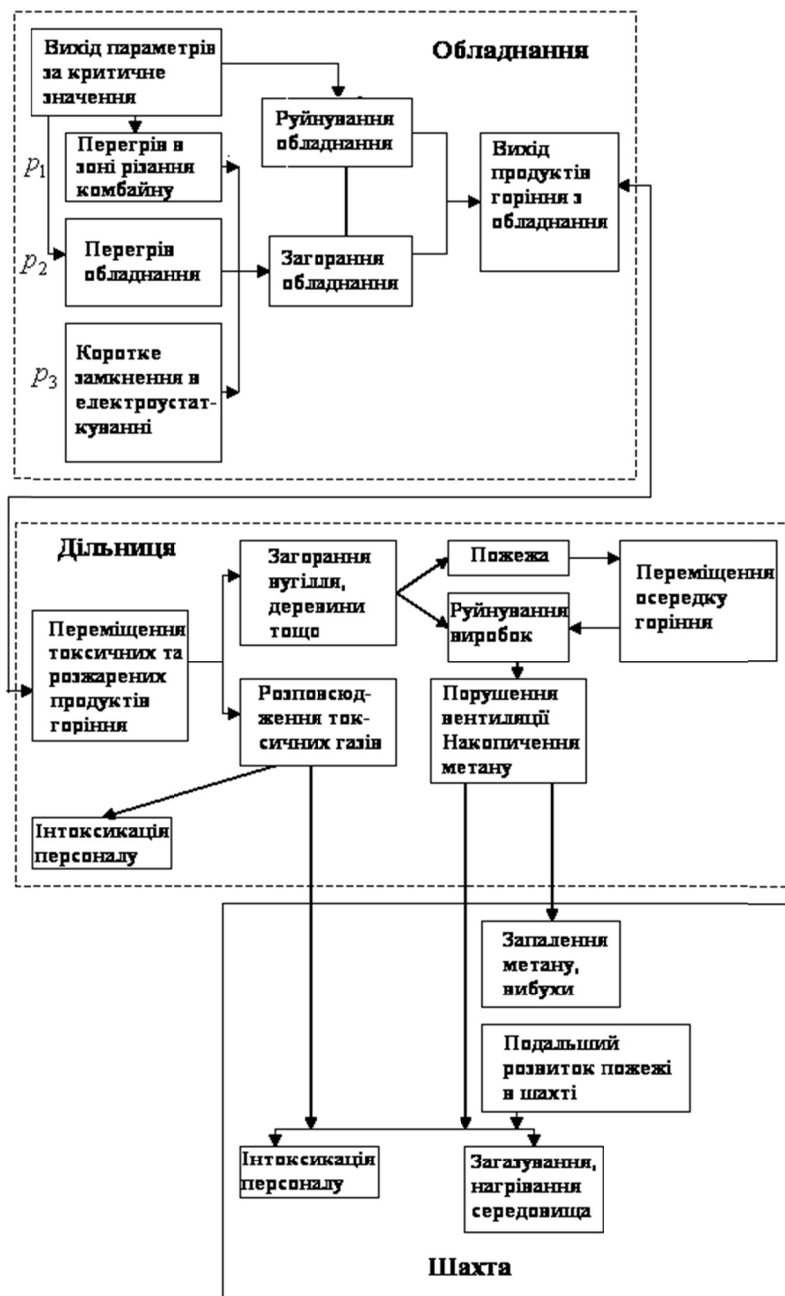
Рис. 1. Схема виникнення і розвитку екзогенної пожежі в шахті
