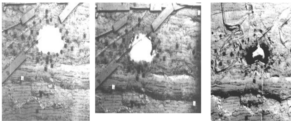
Рис. 5. Картина деформирования сечения модельной выработки при величине критерия 0,83
