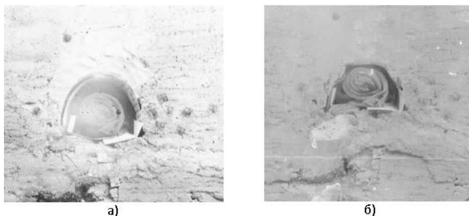
Рис. 3. Состояние сечения выработки при умеренной величине критерия устойчивости: а) исходное; б) конечное
