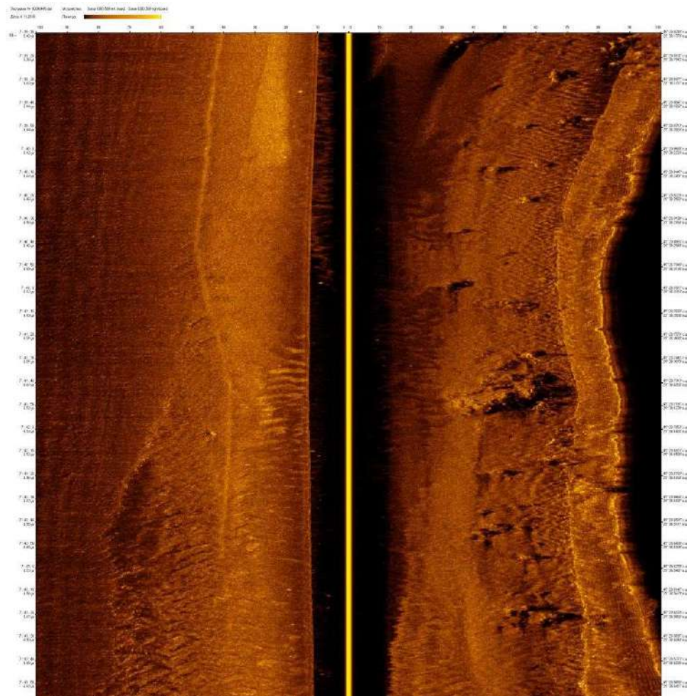
Рис. 19. Приклад ехограми дна р. Дунай (гирло Бистре)
