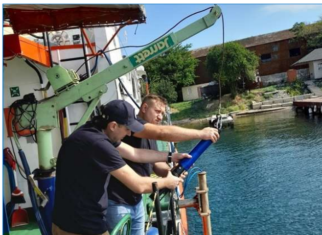
Рис. 13. Підготовка багатопараметричного CTD-зонда суднового комплексу до зйомки гідрофізичних параметрів морського середовища з використанням електричної лебідки "Jarrett" моделі S350-F19001 австралійської фірми "Advansa", яку встановлено на правому борті палуби ВГК "О. Солодунов" (зліва направо: кандидат фізико-математичних наук Олексій Шундель, кандидат геологічних наук Сергій Федосєнков)
