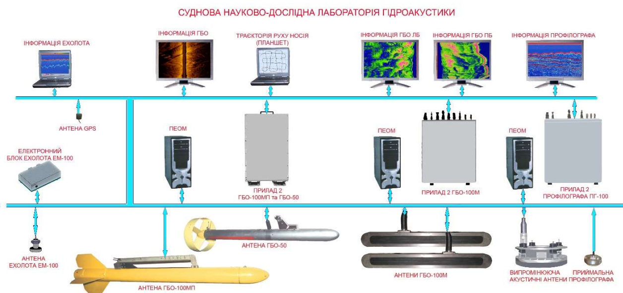
Рис. 1. Функціональна схема суднової модульної науково-дослідної лабораторії гідроакустики
