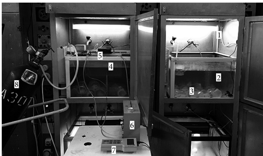
Рис. 1. Експериментальна установка для дослідження впливу кисневого режиму на фізіологічний стан гамарид: 1 — аквакамера; 2 — ємність об'ємом 100 дм 3 ; 3 — реєстраційна камера; 4 — «купол» із газоподібним азотом; 5 — мікрокомпресор; 6 — ротаметр; 7 — оксиметр, 8 — балон із газоподібним азотом
