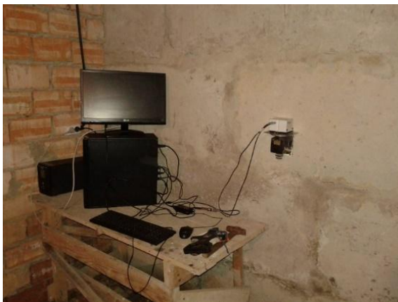
Рис. 4. Нахиломірна станція Nivel 210 встановлена в школі с. Модричі
