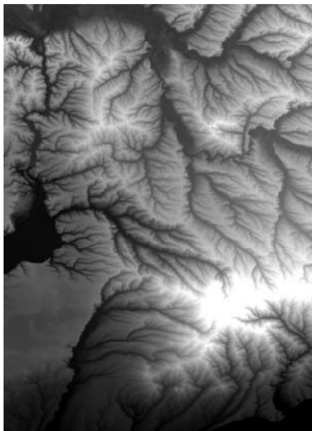
Рис. 5. Район Оріхово-Павлоградської міжблокової зони і прилеглих територій Українського щита. Фрагмент створеної і комп'ютерно обробленої мозаїки сканерних SRTM-зображень, отриманих з КА "Shuttle". Ропізнаються гідрографічна та ерозійна мережі, якісно оцінюється відносне перевищення у рельєфі земної поверхні
