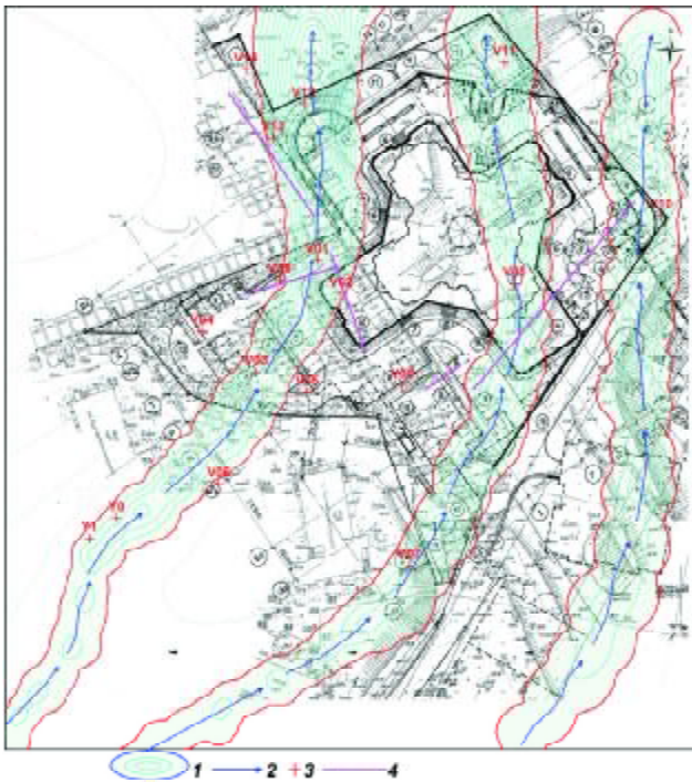
Рис. 3. Карта зон увлажнения почвы и путей миграции подземных водных потоков на участке строительства жилого комплекса (по данным съемки методом СКИП): 1 – зоны увлажнения грунтов; 2 – направление миграции грунтовых вод; 3 – пункт ВЭРЗ; 4 – профили георадарного зондирования
