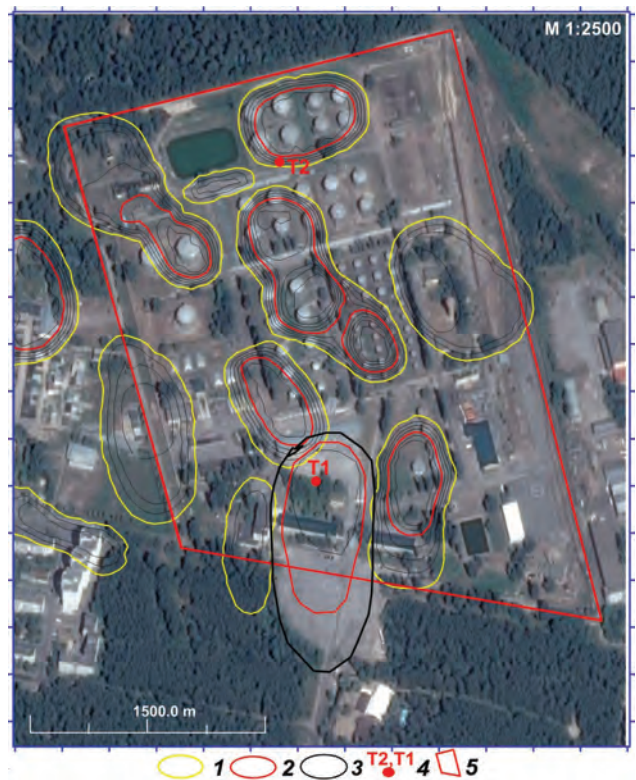
Рис. 8. Карта геоэлектрических аномальных зон типа “техногенная залежь топлива” на спутниковом снимке территории нефтебазы (по данным частотно-резонансного дешифрирования спутниковых снимков). Резонансные частоты пробы 2: 1 – контуры аномальных зон; 2 – наиболее перспективные поисковые зоны; 3 – контур аномальной зоны по резонансным частотам пробы 1; 4 – скважины отбора образцов топлива; 5 – границы нефтебазы
