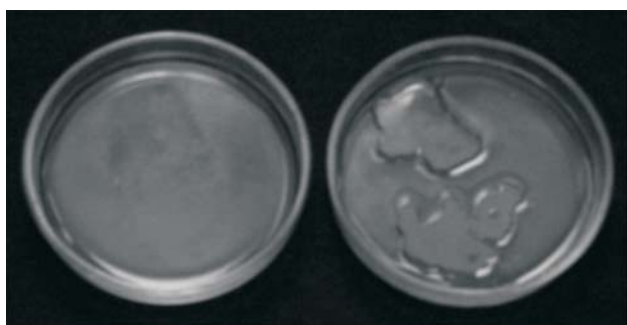
Рис. 4. Ліворуч: 5 мл води з потенціалом -200 мВ повністю вкривають дно чашки Петрі, праворуч: 5 мл води з потенціалом +200 мВ не вкривають дна чашки Петрі повністю [7]
