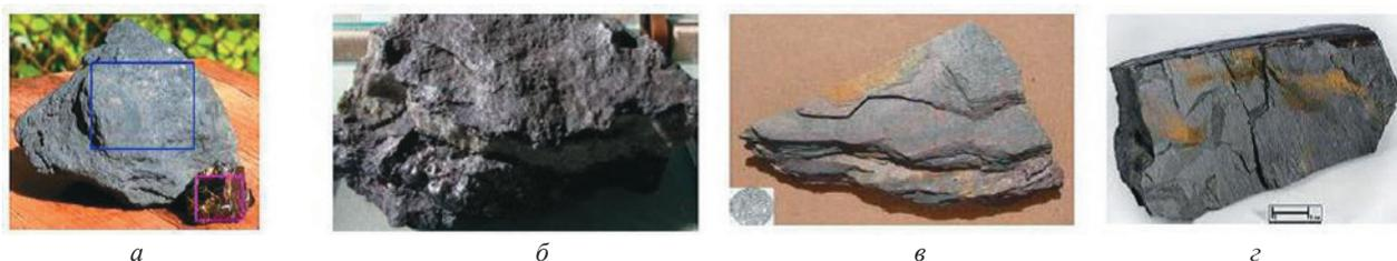
**Рис. 14.** Фотоснимки образцов шунгита *a*, графита *б* и аспидных сланцев *в, з*
