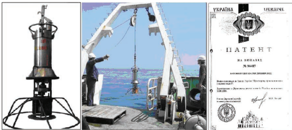
Рис. 12. Герметический батометр-дегазатор (глубина исследования до 2000 м)
