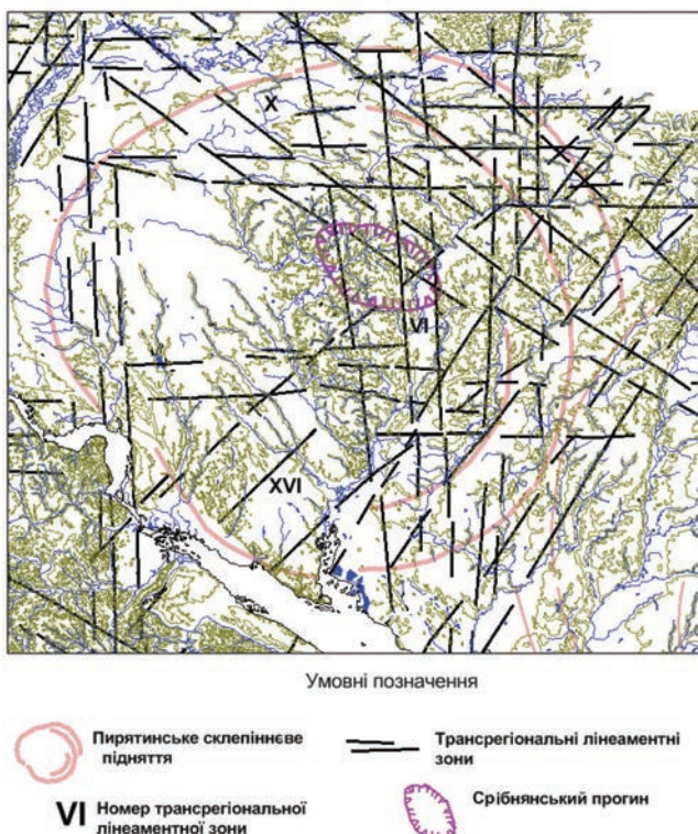
Рис. 4. Структурно-неотектонічне дешифрування Срібнянської депресії на основі фрагмента карти лінійних та кільцевих структур (за О.О. Янцевичем)
