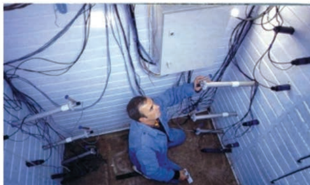
Шурф для моніторингу зони аерації
