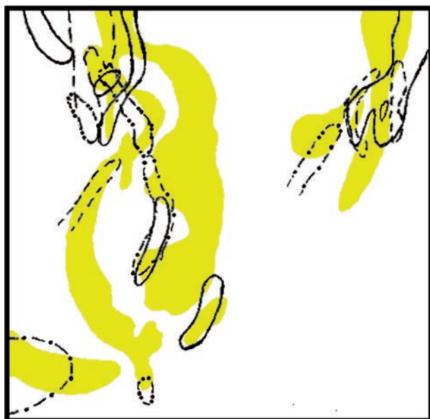
Рис. 2. Схема площового поширення аномалій золота та мінералів у конгломератах Білокоровицької структури
