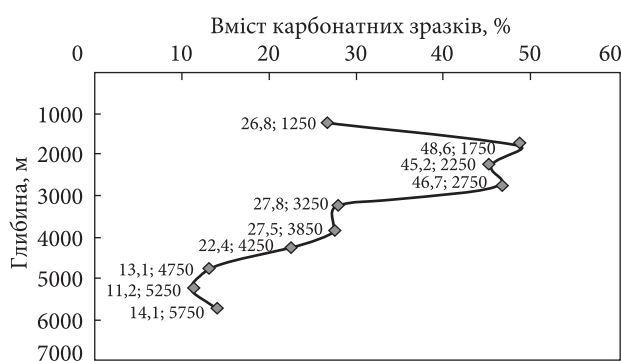
Рис. 6. Розподіл карбонатних зразків за глибиною для північного борту та прибортової зони ДДЗ
