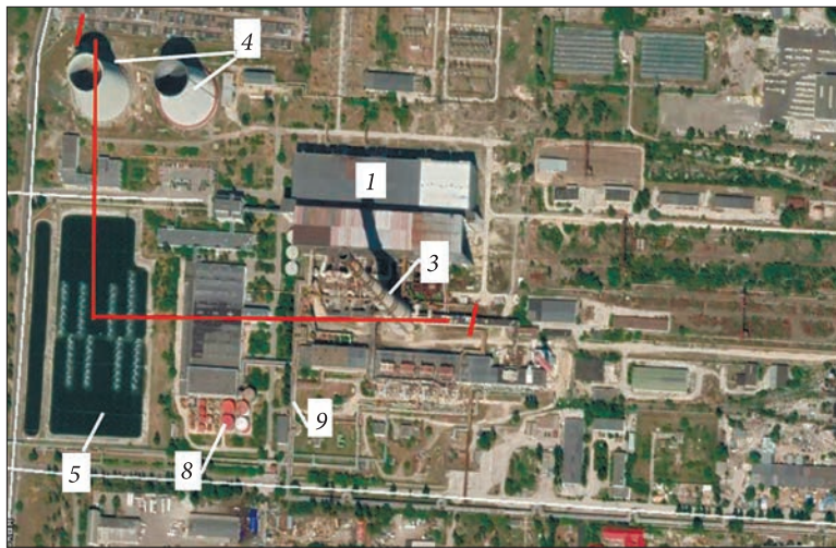
Рис. 2. Об'єкти ТЕЦ на типовому генеральному плані-схемі (а) та на загальному вигляді ТЕЦ-6 Києва (б), ТЕЦ-5 Харкова (в): 1 — головний корпус (котельня, турбінне відділення); 2 — головний щит управління; 3 — димові труби; 4 — градирні; 5 — резервуари технічного водопостачання; 6 — ставок стічних вод — золівідстійник, відстійник вапняного шламу; 7 — хімічне водоочищення; 8 — масло-мазудо-дизельні господарства; 9 — магістральні трубопроводи; 10 — розподільчі електротехнічні пристрої; 11 — адміністративно-битові та лабораторні корпуси; 12 — об'єднані та допоміжні корпуси; 13 — ресивери; 14 — баки конденсату; 15 — перехідні галереї; 16 — прохідна; 17 — залізниця для постачання та вивезення палива, обладнання та ін.; 18 — статичні та динамічні впливи; 19 — зони можливих витоків; 20 — виточки, утворення термонапруг у ґрунтах; 21 — динамічні впливи; 22 — забруднення; 23 — лінія розрізу І—І
