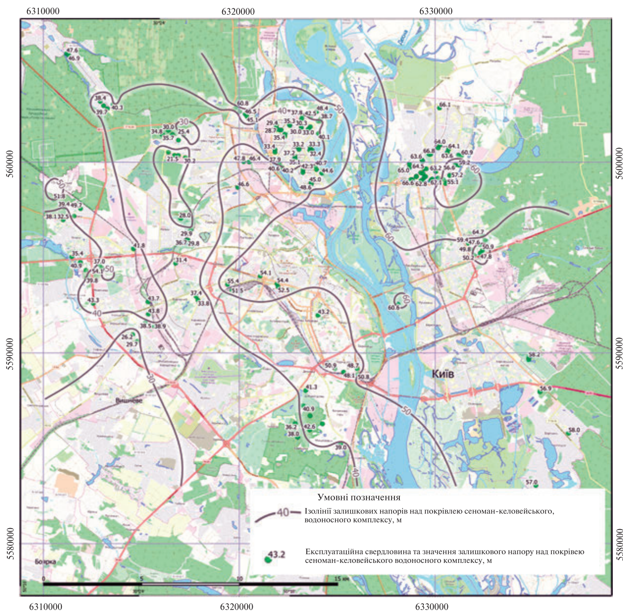
Рис. 6. Карта залишкових напорів над покрівлею сеноман-келовейського водоносного комплексу за результатами розв’язання першого варіанту прогностичної задачі станом на 2043 р.
