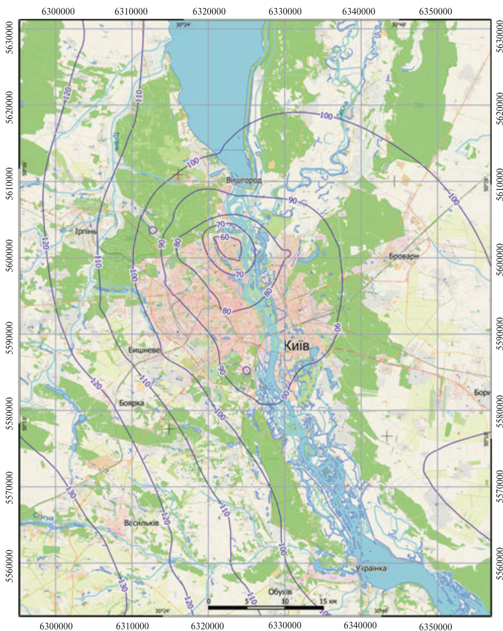
Рис. 4. Модельна карта гідроізоп'єз сеноман-келовейського водоносного комплексу за результатами розв'язання нестационарної оберненої задачі станом на січень 2017 р.
